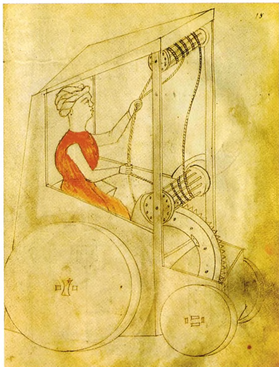
Figur 4. Venezianeren Giovanni Fontana (1395-1455) var bl.a. skaberen af denne muskeltrukne køre-maskine. Det er påfaldende, i hvor høj grad køretøjets udformning minder om børnetegninger af biler. Bemærk, at Fontana selv tilsyneladende er i tvivl om mekanismens finere detaljer, idet træktovet er gengivet ført begge veje rundt om top-akselen på samme tid. Det er iøvrigt en pudsig detalje, at chaufføren på verdens første bil er en kvinde. Maskinen er i princippet operationel, men næppe særlig praktisk: den kan ikke dreje, og kræver betydelig mere energi end blot at spadserere(!)
