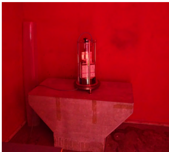
Figur 11. Magnetometer på Station Nord. Apparatet er et såkaldt fluxgate magnetometer, som måler magnetfeltet i tre retninger, og er optimeret til at være stabilt over lange tidsrum. Under opsætningen er sensorakserne blevet orienteret langs lokal magnetisk nord, lokal magnetisk øst og lodret nedad.
