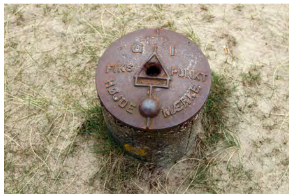
Figur 2. Andenordens fikspunkt i jordoverfladen over en nedsat betonblok. Knoppen under koordinatmærket giver højdekoten. Stationscentret er hullet i midten af kalotten. Fra Klitmøller. Foto: Wikipedia.
