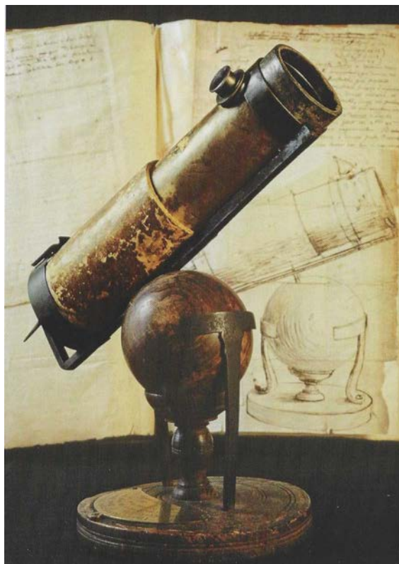
Figur 2. Newtons tegning og et eksemplar af den kikkert, som han konstruerede.
