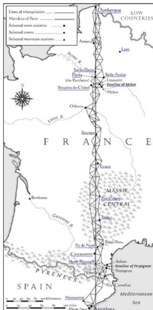
Figur 1. Delambres og Méchains triangulering.
