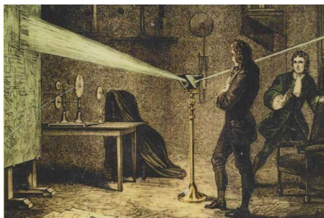
Figur 3. Sollyset sendes gennem et prisme, og et spektrum ses på væggen.
