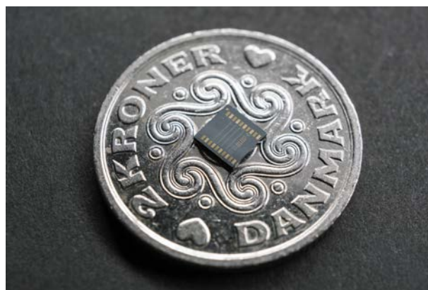
Figur 1. En Sparrow Quantum chip placeret ovenpå hullet i en 2-krone. På denne chip er der 400 små strukturer, der kan udsende og guide enkelte fotoner.
