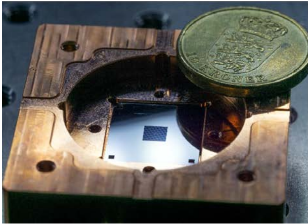
Figur 6. Venstre: En mikrochip med en membran, der kan bruges til at koble elektroniske qubits til fotoniske qubits Højre: Nærbillede af membranen, hvor der yderligere kan ses en capacitor, der kobler til et elektronisk kredsløb (firkant) og en kavititet, der kan oscillere og koble til lys (cirkel).
