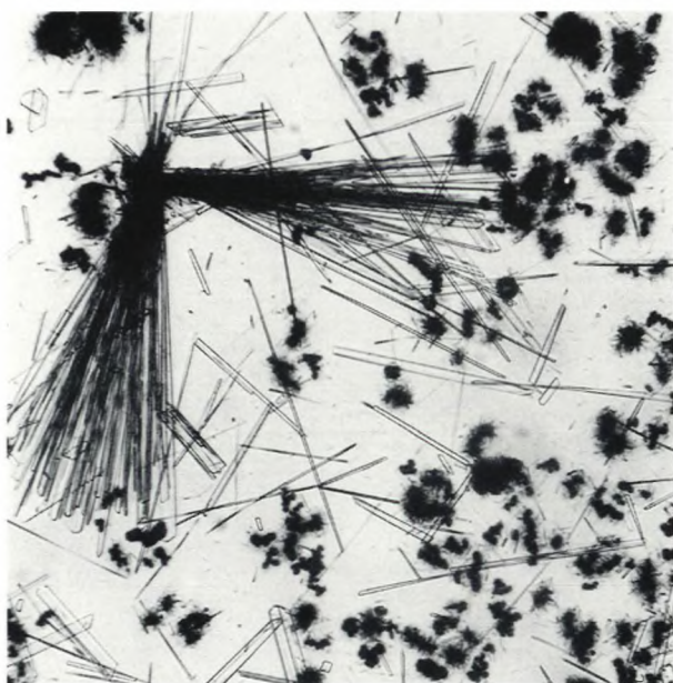
Figur 6. Krystaller i produktet fra rumforsøget, til venstre set i lysmikroskop, til højre i scanning elektronmikroskop. "HAP" og "OCP" betyder hydroxylapatit og oktaaluminiumfosfat.
