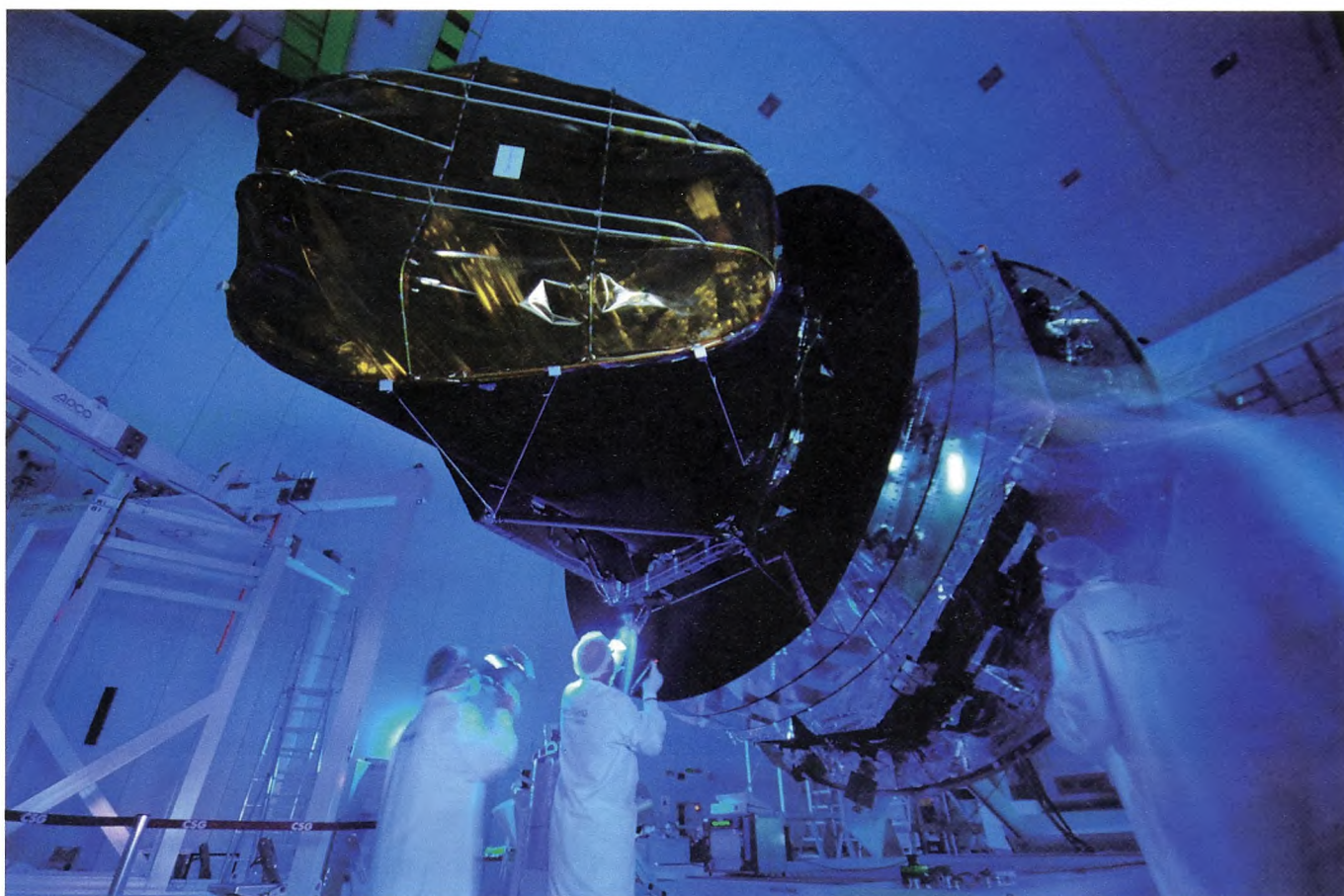
Figur 5. Planck-satellitten. Teknikerne foretager den sidste omhyggelige rengøring i det specielle rene rum i Kourou, Fransk Guyana.
