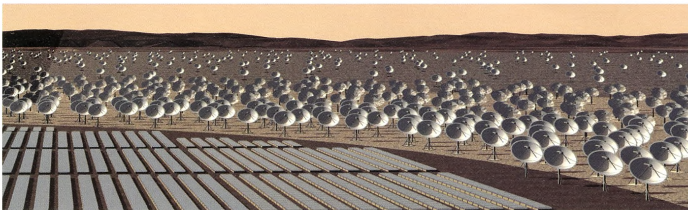
Figur 18. En tegning af den centrale del af SKA. Radioteleskopet består af flere tusinde antenner med et samlet areal på 1 km 2 [10].
