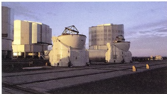
Figur 12. To af de mindre teleskoper på 1,8 m som kan indgå i observation med de store 8,2 m VLT teleskoper (ESO).
