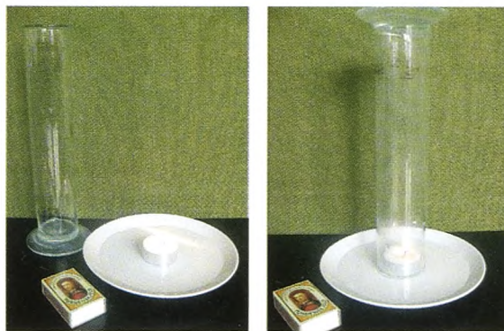
Figur 4. Til venstre: Tallerken med lidt vand og et tændt fyrfadsllys samt en glaskolbe. Til højre: Glaskolben placeres over lyset.
