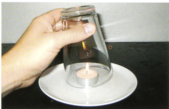
Figur 2. Vandet hældes i tallerkenen og lyset placeres i midten og tændes. Det tomme glas placeres over lyset.
