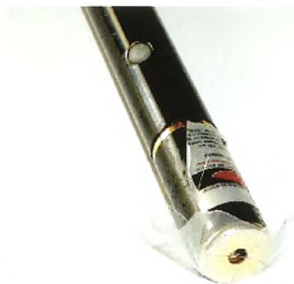
Figur 2. En metaltråd på 0,1 mm er sat fast med tape hen over åbningen på en laserpointer. I stedet for metaltråd kan man måle på tykkelsen af et hår.
