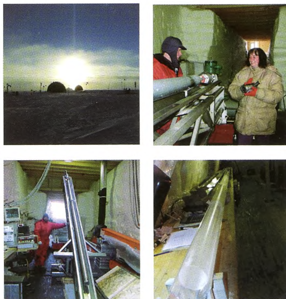
Figur 2. NGRIP lejren i midnatssolen – artiklens forfatter i borehallen – boret på vej til at blive sænket ned i hullet – og en iskerne fra dybet af den grønlandske iskappe. Boret er ti meter langt og kan hente tre meter iskerne op ad gangen. Iskernen har en diameter på ti centimeter.
