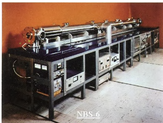
Figur 1. Primær sekundstandard baseret på en stråle af cæsiumatomer. Dette ur var den amerikanske tidsstandard fra 1975 til 1993.
