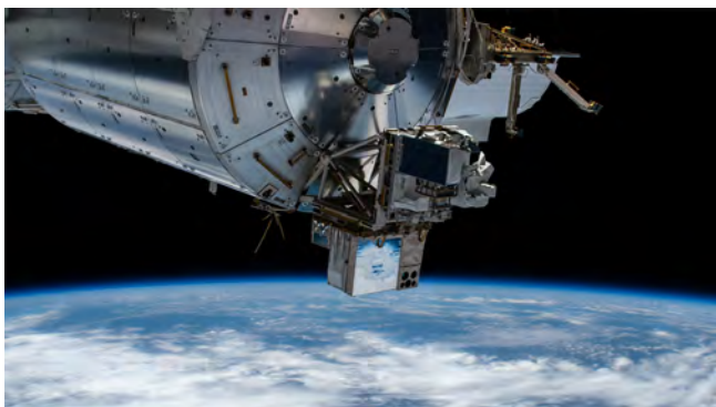
Figur 5. ASIM er den blå kasse, som her ses monteret på det europæiske Columbus-modul på Den Internationale Rumstation ISS. Foto: NASA.
