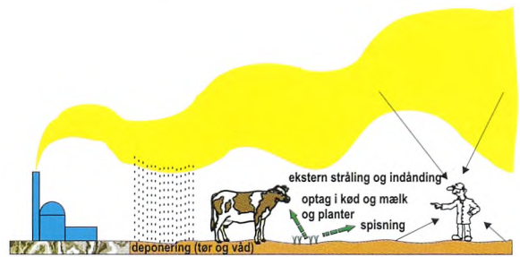
Figur 5. Eksponeringsveje fra et atmosfærisk udslip af radioaktive stoffer. De dominerende eksponeringsveje er normalt indånding af forurenede luft og spisning af forurenede fødevarer.
