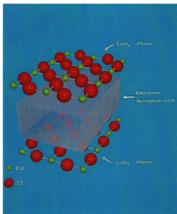
Figur 1. Skematisk beskrivelse af de strukturelle komponenter i høj T_c superledere, bestående af de superledende \text{CuO}_2 planer og elektron acceptor enheden, som skaber de for superledningen nødvendige huller i disse planer.
