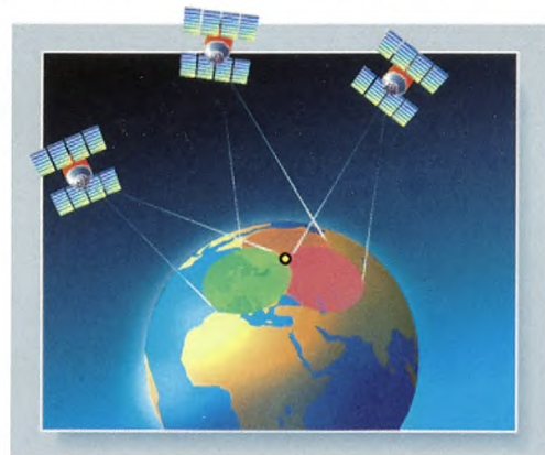
Figur 9. Princippet i det Globale Positionerings-System (GPS). De tre satellitter giver modtagerens præcise position i deres signalers fælles skæringspunkt med Jordkloden. Illustration: Troels Marstrand.
