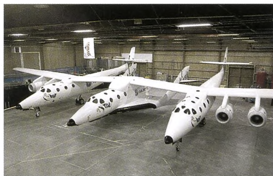
Figur 3. Rumskibet "SpaceShipTwo", monteret under flyet "WhiteKnightTwo", som skal bære det højt op i atmosfæren inden affyringen.
