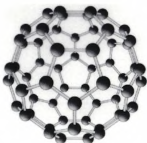
Figur 1. Struktur af C_{60} , buckminsterfulleren-molekylet
