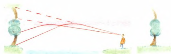
Figur 13. Princippet i en svævende luftspejling. Her giver en temperaturinversion anledning til at lysstråler sendt opad fra et objekt kastes tilbage mod Jorden. Tegning af Claus Rye Nielsen.
