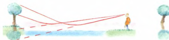
Figur 10. Princippet i en normal luftspejling. Luftlaget over overfladen er varm i forhold til luften længere oppe. Dermed afbøjes de lysstråler fra træet, som strejfer dette luftlag, opad. De afbøjede lysstråler giver et spejlbillede af træet. Tegning: Claus Rye Nielsen.
