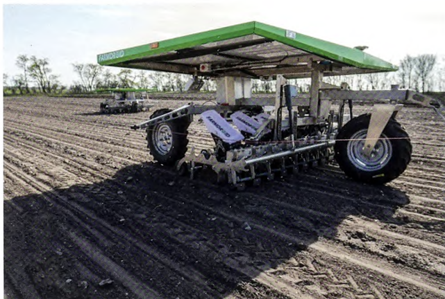
Figur 1. Markroboten FarmDroid FD20 vejer 900 kg og har en kapacitet på 20 ha. Tophastigheden er omkring 1 km/t.
