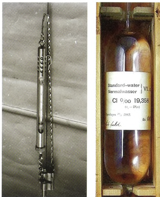
Figur 7. Knudsens vendetermometer og ampul med "Standard Seawater".
