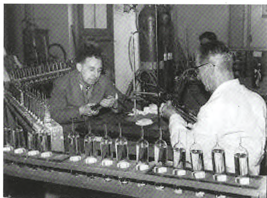
Figur 8. Ampulfremstilling af "Standard Seawater" (normalvand). Foto fra 1960'erne.
