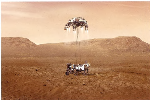
Figur 1. "Himmelkranen" fungerer meget som en helikopter, der ved hjælp af kabler sænker roveren ned til overfladen. Så snart roverens hjul rammer overfladen, klipper den kablerne over og flyver væk fra landingsområdet.
