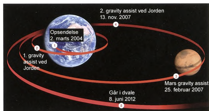
Figur 4. Slangebøsseffekten blev udnyttet flere gange for Rosetta-satellitten (oversat fra Daily Telegraph).
