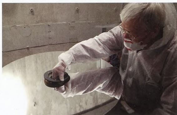
Figur 3: Knud Seifert indsætter centerfatningen efter, at spejlet er blevet re-aluminiseret. Foto: Michael Lindholm Nielsen
