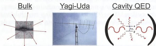
Figur 8: Venstre: Kvante-emitter i et ustruktureret “bulk”-materiale. Midt: Yagi-Uda-antenne opererende ved radiobølglængder. Højre: Kvante-emitter i en optisk kavitet.
