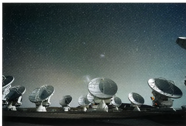
Figur 2. Atacama Large Millimeter/submillimeter Array (ALMA) på Chajnantor-plateauet i det nordlige Chile. Ved at kombinere signalerne fra de 66 radioantenner kan man bruge ALMA til at lave billeder svarende til observationer fra et enkelt teleskop med en diameter svarende til udstrækningen af de 66 radioantenner. Foto: ESO/C. Malin.
