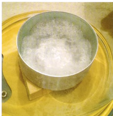
Figur 2. Et close-up af dåsen med nitrogen – på fast form – i vakuumblokken (figur 1).
