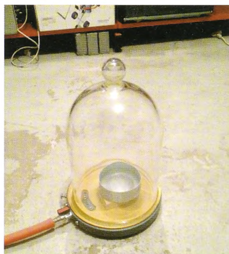
Figur 1. I en vakuumblokke vil flydende nitrogen omdannes til fast form og gasform.
