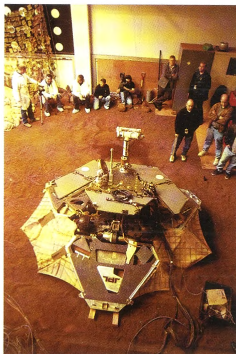
Figur 2. En hal på JPL's campus rummer et simuleret Mars-landskab, hvor forskerne kan teste planlagte manøvrer med robotbilerne, før kommandoerne bliver sendt af sted til Mars. Her er forskere og teknikere ved at teste udrulningen af Opportunity fra platformen. Testen foregik mellem kl. 2 og 3 om natten. (Foto: Sune Nordentoft Lauritsen).
