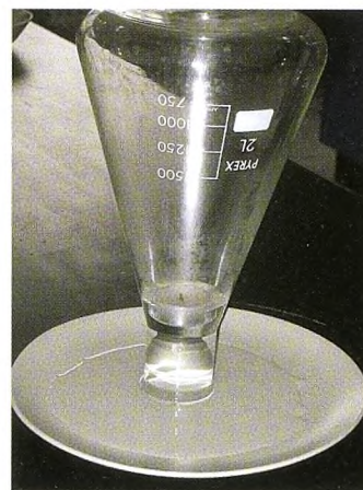
Figur 3. Vandet løfter stearinlyset ca. 8 centimeter op i en buttet (konisk) 2 liter glaskolbe (som jo forefindes i ethvert kemilokale)
