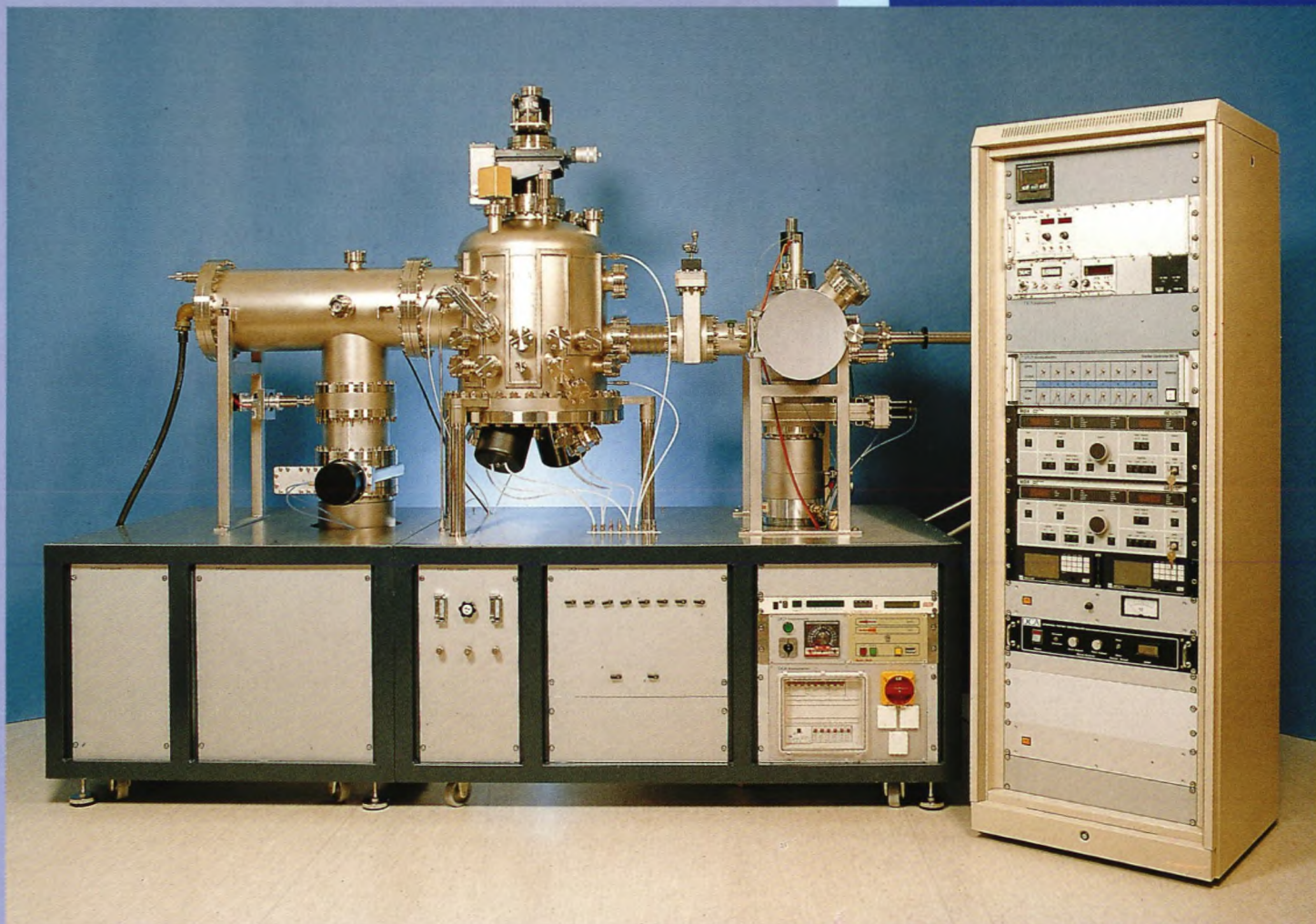
MTD-450 med to magnetronkilder og fire effusions celler.
