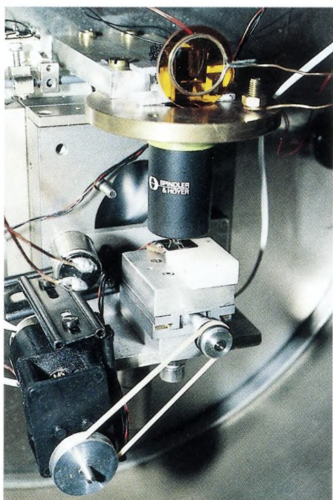
Figur 6. Billedet viser den eksperimentelle opstilling til lasertegning. Laserlyset kommer ned fra oven og fokuseres med mikroskopobjektivet. Midt i billedet ligger de superledende film (sort) på en hvid teflonblok. Nederst ses motordrev til bevægelse af filmen i laserstrålen.
