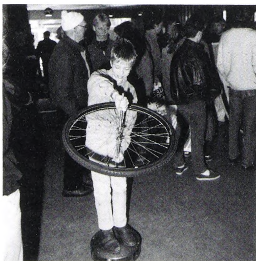
Figur 1. Drengen står på en drejeskive, der kan dreje næsten uden gnidning. Når omdrejningsaksen på det roterende cykelhjul, han holder i hånden, drejes, vil dreng + cykelhjul rotere rundt med drejskiven, jævnfør impulsmomentsætningen.
