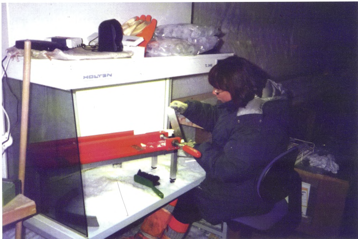
Figur 4. Forfatteren renser et stykke iskerne til kemisk analyse. Arbejdet foregår i en laminarbænk.
