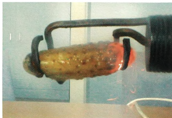
Figur 4. Efter lidt tid begynder agurken at lyse. Farven stammer fra den gule D-linie i natrium. Bemærk at farverne på billedet ikke er gengivet helt korrekt!
