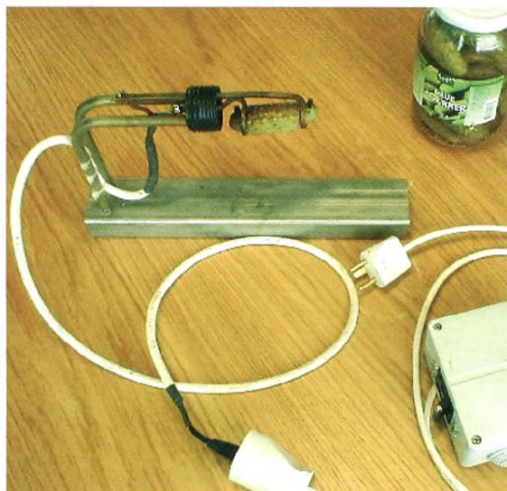
Figur 2. En agurk er klar til at blive "henrettet" i en elektrisk stol indrettet til formålet. Elektroderne kobles direkte til stikkontakten via en sikring.
