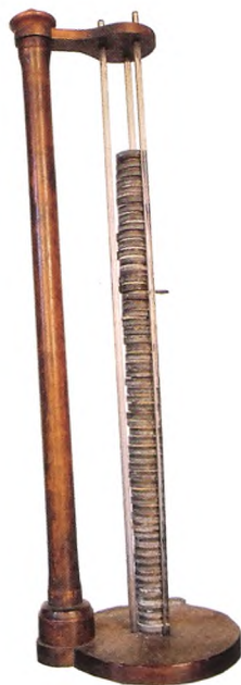
Figur 2. Voltasøjle bestående af en søjle af to gange ca. 60 kobber- og zinksiver adskilt af papskiver vædet med en saltopløsning, 1802. Herlufsholm Skole. Foto: D. Ch. Christensen.
