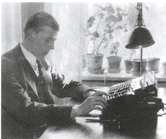
Figur 4. Her benytter Bengt Strömghren i 1930'erne en elektrisk regnemaskine, som kunne multiplicere eller dividere to store tal med hinanden på omkring et minut. Dengang var en sådan maskine en avanceret og ret kostbar sag. Fra [6].
