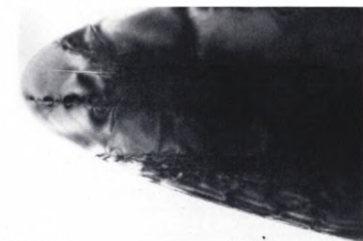
Figur 3. Oversigtsbillede af wolframspids, som viser mange lavvinkelkorngrenser.
