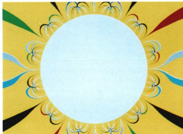
Figur 10. Simulering af hul med bølgeformet kant overlejret med en ikke vinkelafhængig udbøjning vinkelret på hullet.
