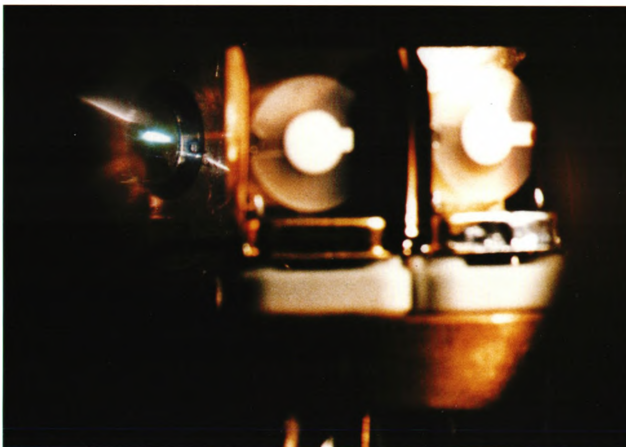
Figur 4. Et stærkt lysende (blåligt) sølvplasma i vakuum foran target ses til venstre på figuren. Laserpulsen på 355 nm (kan ikke ses) kommer ind fra venstre. Pulseenergien på 50 mJ og længde 6 ns giver her til en intensitet på 0.5 \text{ GW/cm}^2 . De "tallerken- lignende" to plader til højre er mikrovægte på holdere, der bruges til måling af hvor meget sølv, der udsendes fra target. Billedet stammer fra en optagelse på Risø.
