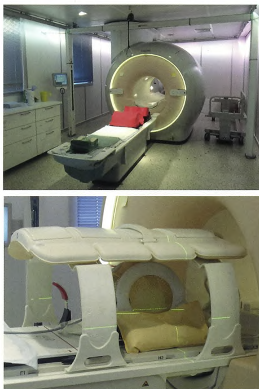
Figur 1. MR-scanner dedikeret til MR-scanninger anvendt til planlægning af stråleterapi (øverst) og eksempel på spolesetup i forbindelse med MR-scanning af patienter fikseret i plastikform til hovedet (nederst).
