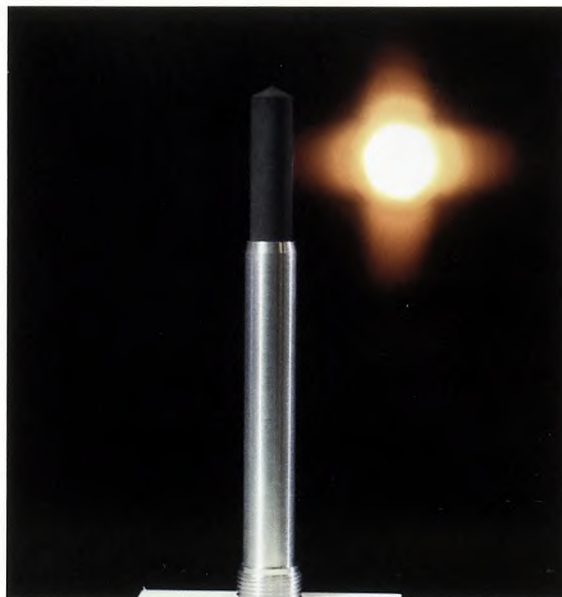
Figur 2. Cylinderformet ionkammer med luftfyldt volumen på 0,65 \text{ cm}^3 af den type hospitalerne anvender til at kalibrere deres accelerators med. Kammervæggen er af grafit og centerelektroden er af aluminium. Typisk anvendes kammeret med en potentialeforskel på 300 V mellem kammer og centerelektrode. Kammeret er åbent til den omkringværende luft, så der skal korrigeres for ændringer i temperatur og atmosfæretryk. Den ladning der dannes, når strålingen ioniserer luften, måles med et elektrometer via et 15 m langt kabel.
