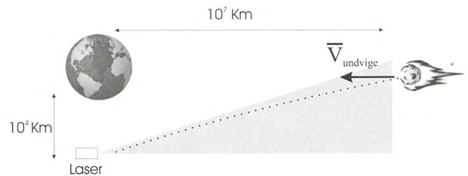
Figur 4. Skitse af hvordan en langdistance optisk pincet monteret på en rumstation forestilles at kunne ændre en asteroides bane fra kollisionskurs med jordkloden.
