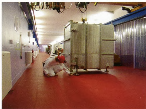
Figur 2. Vakuum-kammeret til mørkt stof-detektoren under installation i Boulby-laboratoriet.
