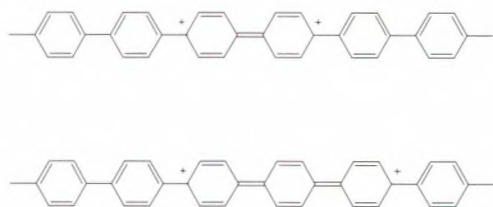
Figur 8. Adskillelse af ladningerne i polyparaphenylen kræver omlejring fra benzoid til quinoidstruktur, vist for bipolaroner.
