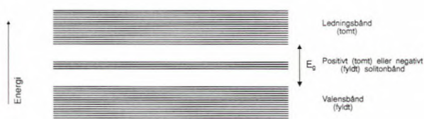
Figur 7. Båndstrukturen i polyacetylen efter doping. (Fra ref. 3).
