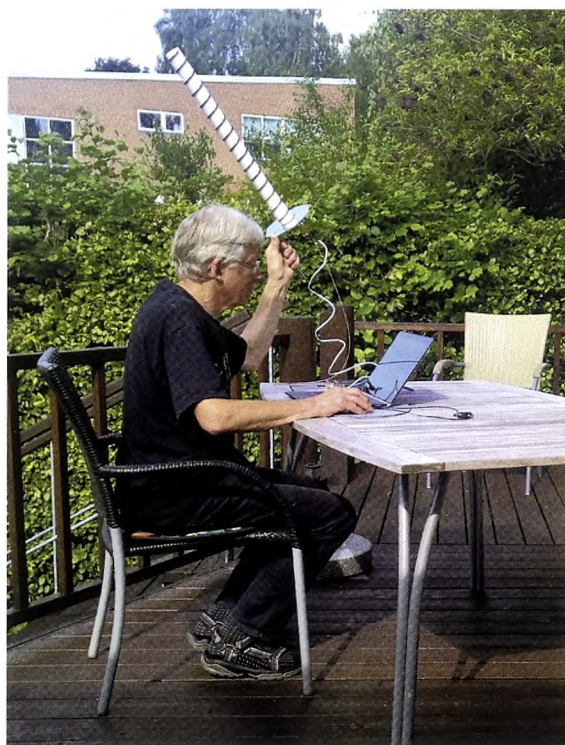
Figur 4. Modtagning af Ørsted signaler med håndholdt helix-antenne (privatfoto).
