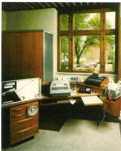
Figur 5. Et GIER anlæg praktisk taget taget magen til Observatoriets 1964 maskine. Det ses, at opstillingen er næsten som i det gamle anlæg. Strimmellæseren er nu den stærkt forbedrede RC2000 og designet er af væsentlig højere kvalitet end før. Fra [2].
